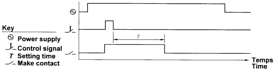
图 3 有控制信号的释放延时继电器
