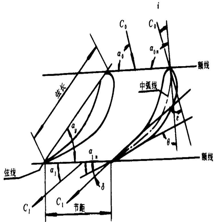
$\alpha_y$ —安装角;  $\alpha_{0n}$ —叶片进口角;  $\alpha_{1n}$ —叶片出口角;  $\alpha_0$ —进汽角;  $\alpha_1$ —出汽角;  $e$ —气流折转角;
